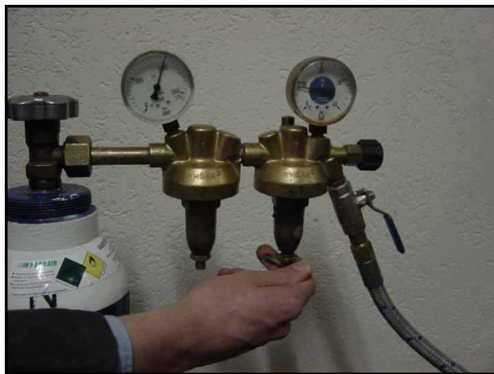
Abbildung 5: Einstellung des richtigen Fließdruckes
