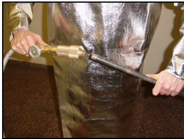
Abbildung 4: Anschluß des Brennröhres
