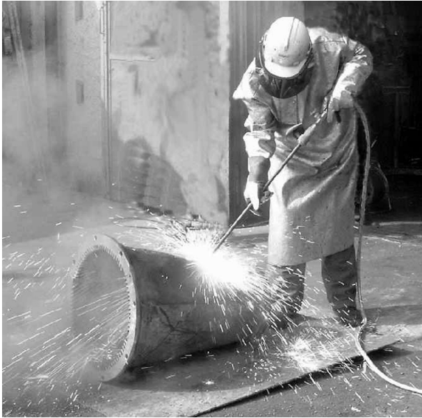
Bild 15. Zerschneiden eines Behälters.
