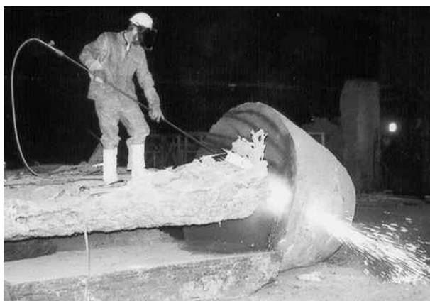
Bild 13. Zerschneiden eines Pfannenbärs.
