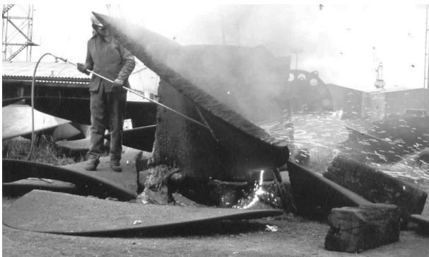
Bild 16. Zerschneiden eines Schiffspropellers.
