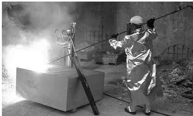
Bild 10. Brennen eines Aluminiumblocks.
