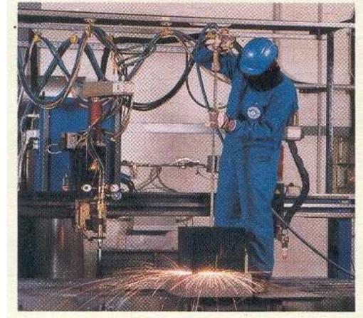
Das sogenannte Lochstechen ist beim Schneiden von Konturen häufig unverzichtbar. Ein Vorgang, bei dem ein normaler Schneidbrenner spätestens bei einer Blechdicke von 150mm an Grenzen stößt. Der Prozess kann instabil werden, denn das Gerät wird hoch belastet. Trotzdem muss nicht gleich aufwendig mechanisch gebohrt werden.
